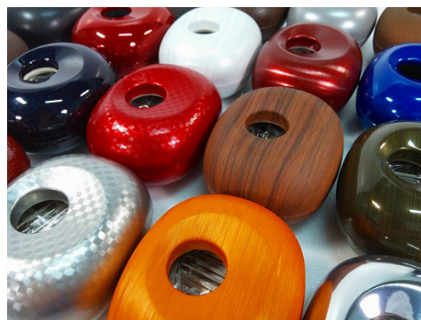
図-1 真空圧空成形による加飾フィルムの貼り合わせ（布施真空(株)様ご提供）
